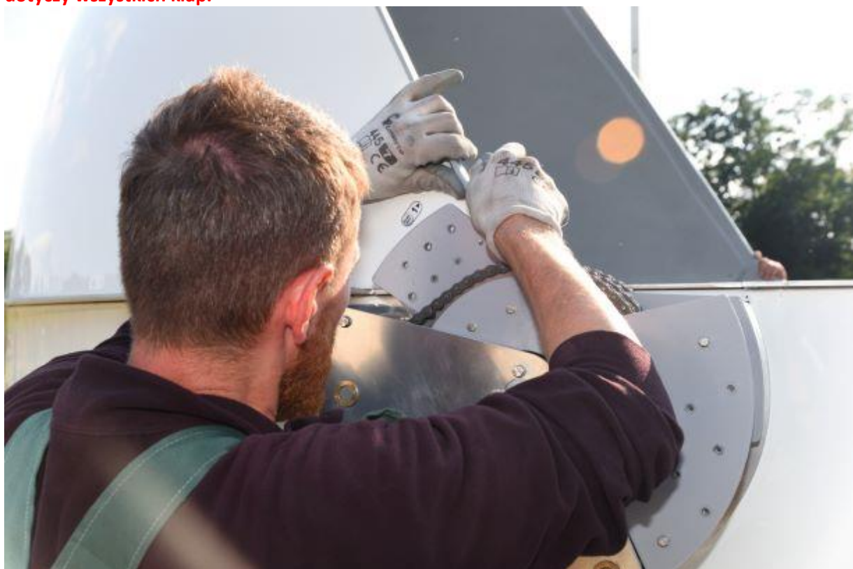
Rys. 40 – osadzenie klapy nr 1 w uchwytych.
