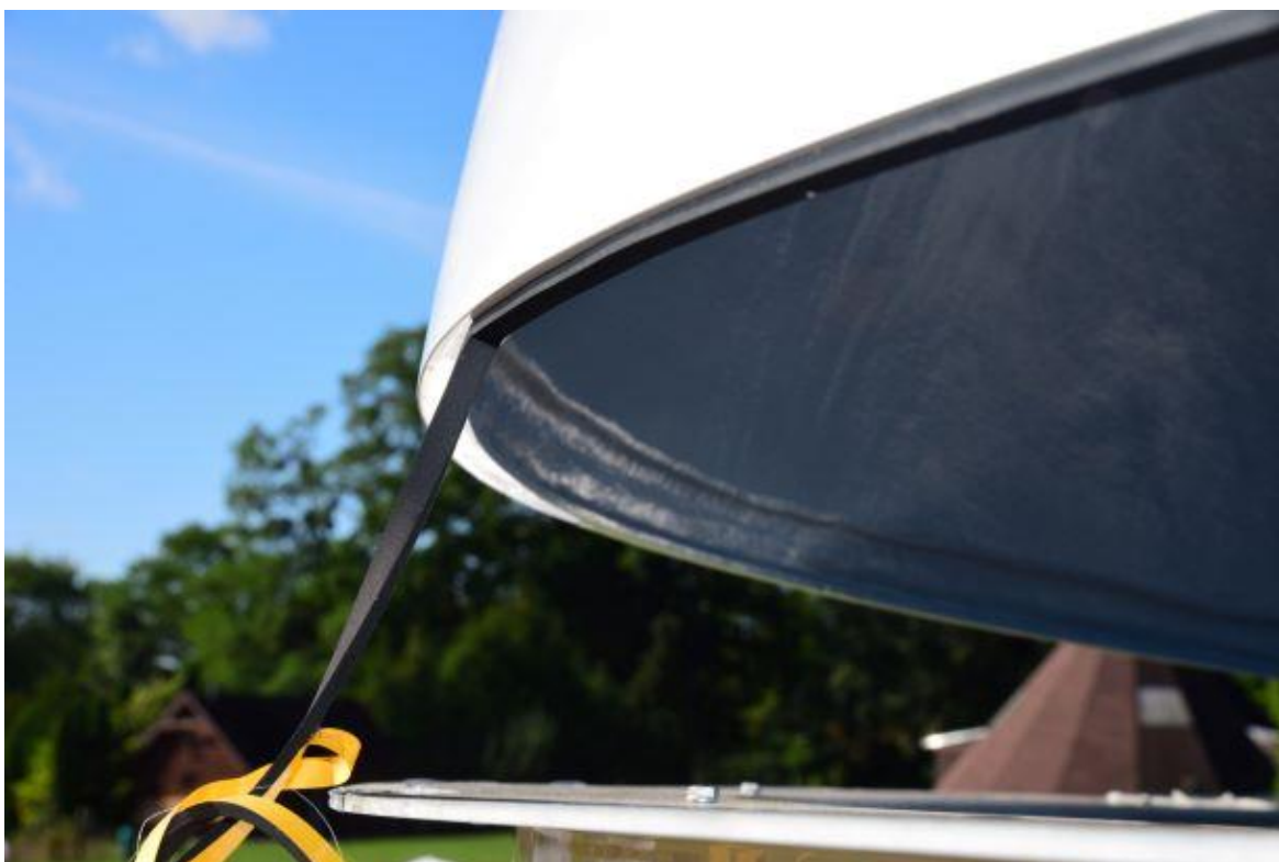
Rys. 65 – Montaż uszczelki na krawędzi pokrywy nr 1.
