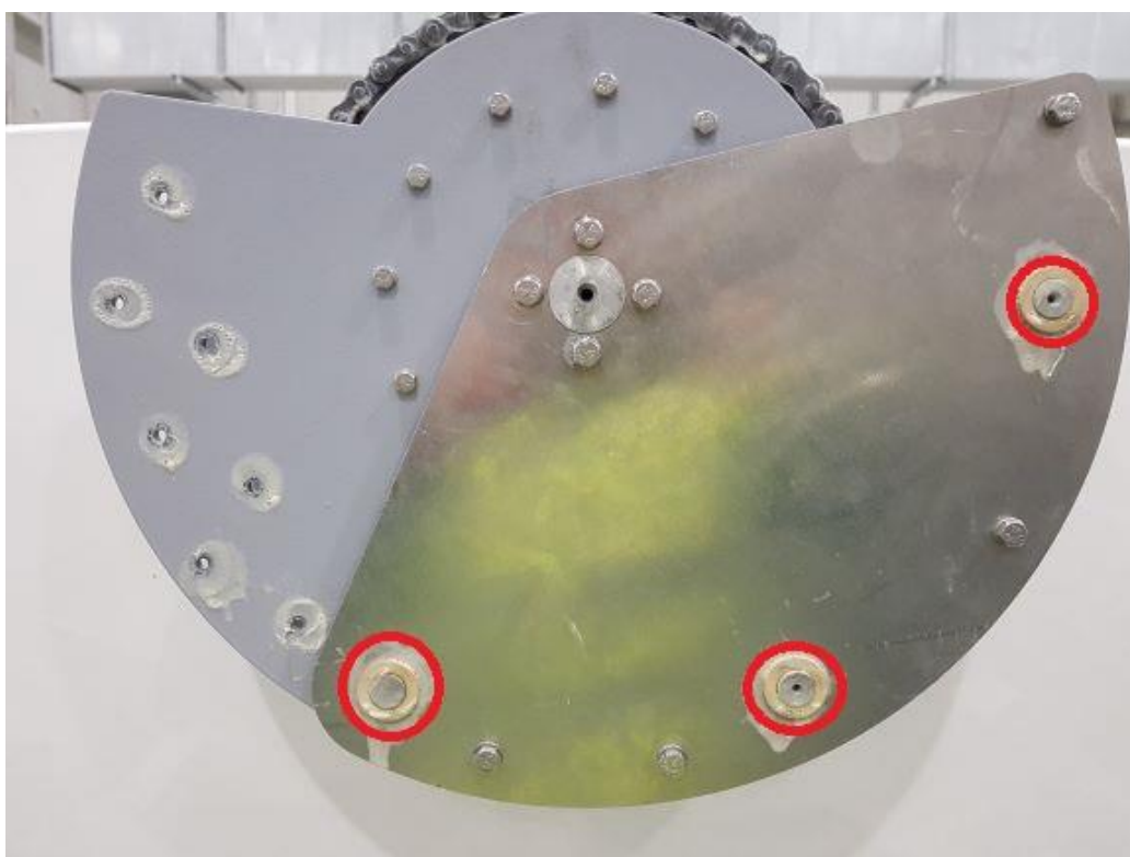
Rys. 75 – Punkty smarowania łożysk końcówek osi
