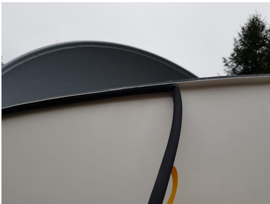
Rys. 67 – Sposób przyklejania uszczelki na pokrywie nr 2
