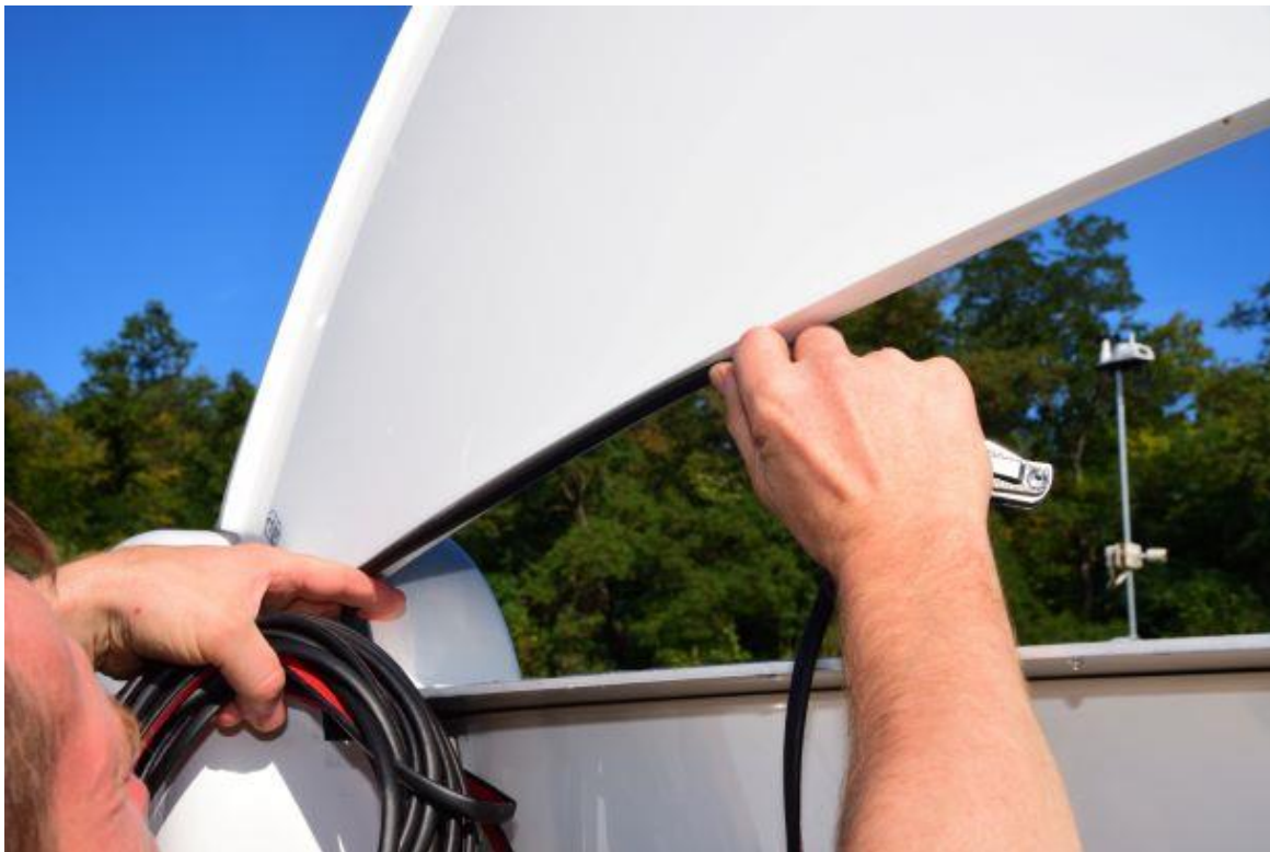
Rys. 63 – Podniesiona pokrywa nr w celu instalacji uszczelki.
