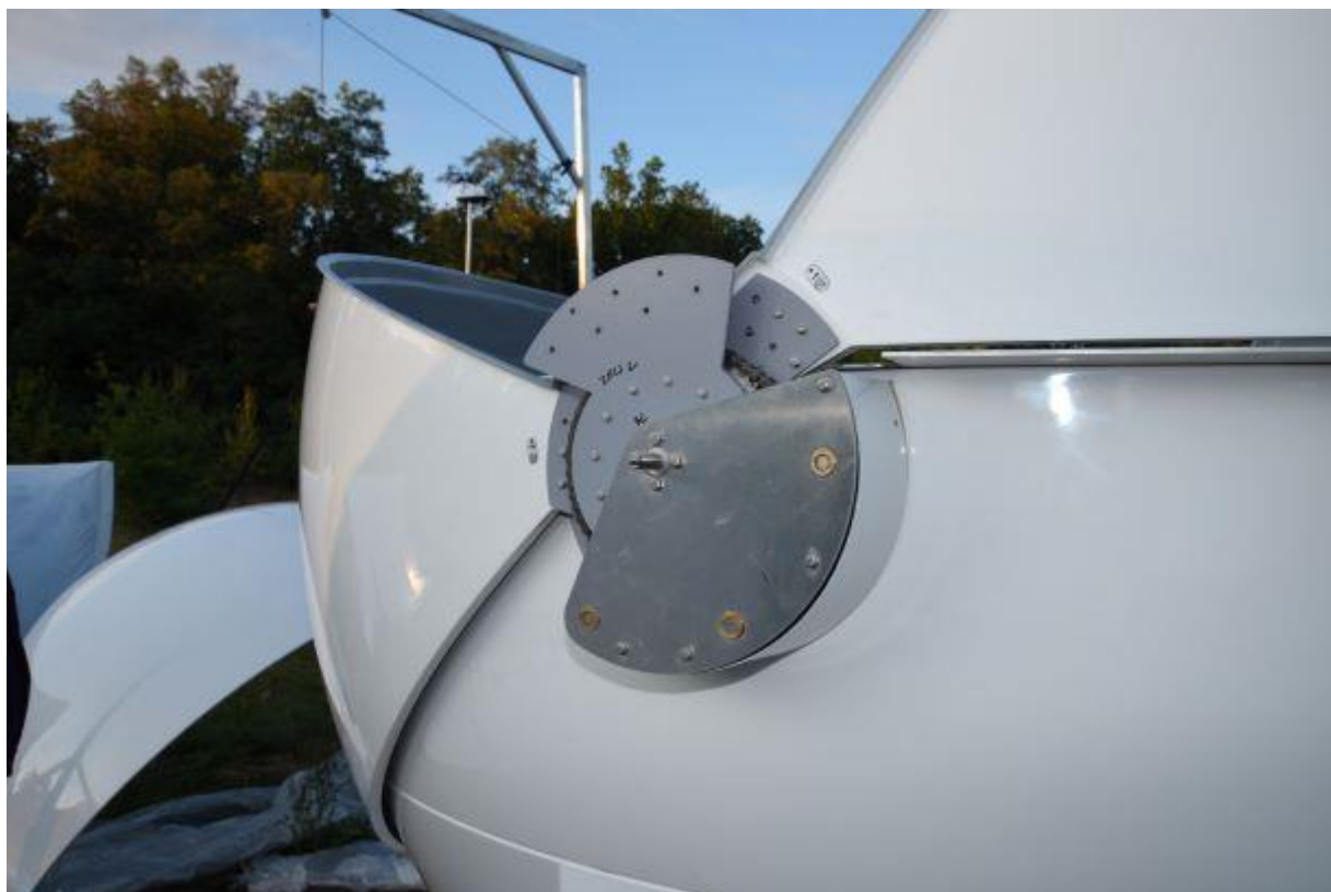
Rys. 49 - pokrywa nr 2 w pozycji częściowo otwartej. Pokrywa nr 1 pozycji zamkniętej.
