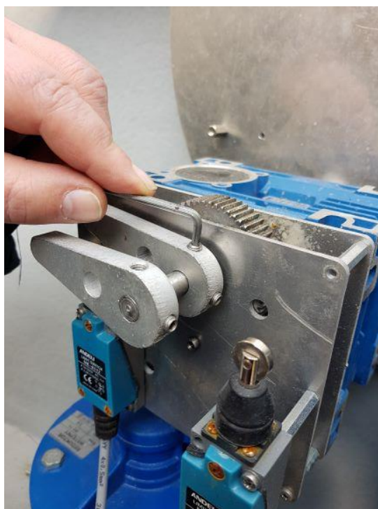
Rys. 73 –Widok wyłącznika krańcowego i jego popychacza w momencie regulacji
