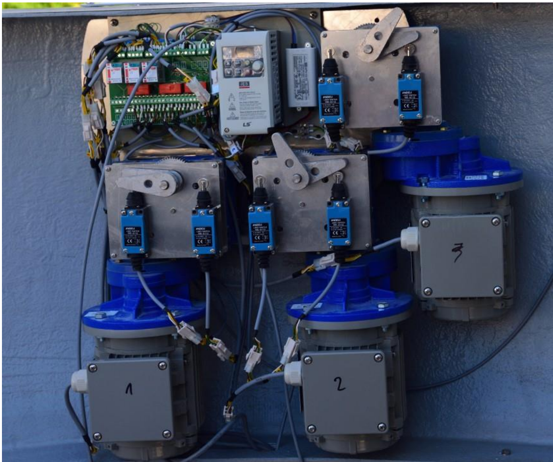
Rys. 72 –Widok zespołu wyłączników krańcowych i zespołu napędowego
